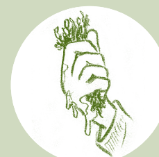
› Matériau trop humide
