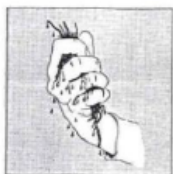
Matériaux trop humide : l'eau s'égoutte entre les doigts
