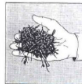
Matériau trop sec : la structure ne se conserve pas
